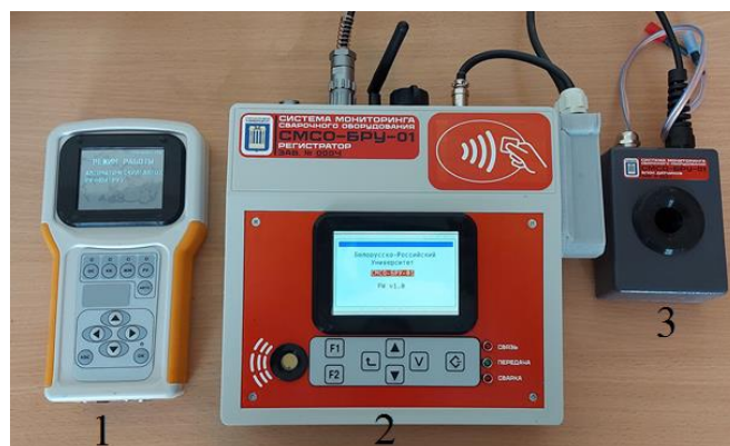
Рис. 1 – Аппаратная часть автоматизированной системы: 1- основной блок регистратора; 2- пульт сварщика; 3 – блок датчиков
